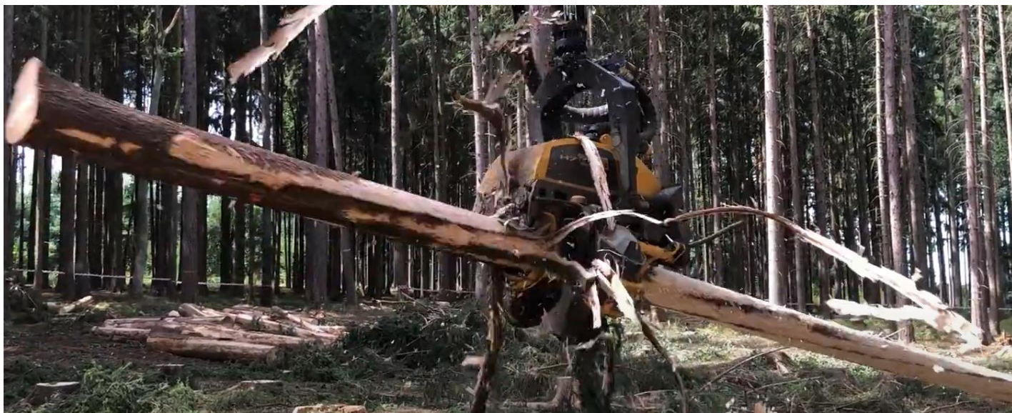
Intenzivní ochrana lesů před kůrovci – harvesterové odkornění lapáků.
